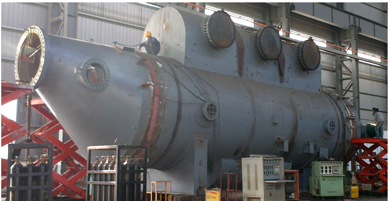
Der größere Turbinenkondensator während der Fertigung in China. Die beachtlichen Ausmaße zeigen den großen Umfang des Projekts.
