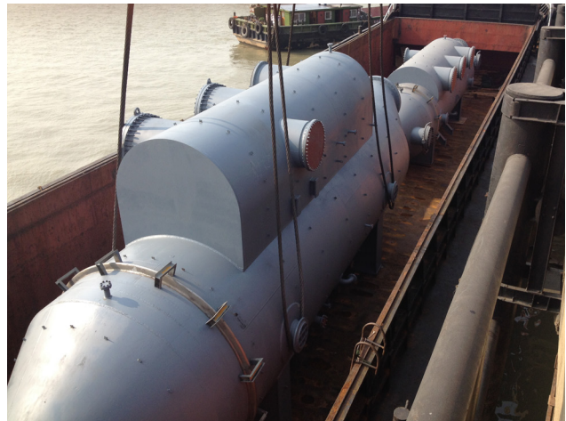
Verladung der beiden Kondensatoren für den aufwendigen Transport.
